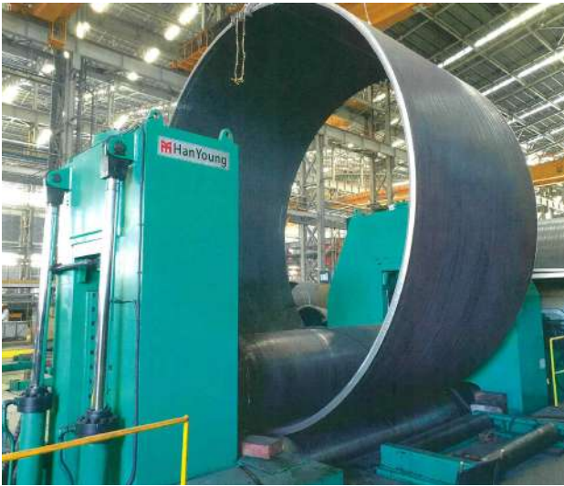
(주)SK오션플랜트 납품 (풍력발전용 하부구조물 모노파일 생산기계)
