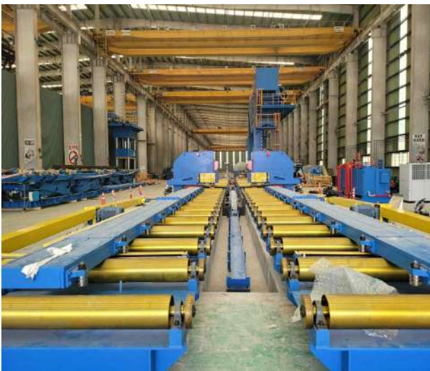
군산조선해양기술사업협동조합 납품 (JCO공법 파이프 생산 PRESS 6,000TON × 12M)
